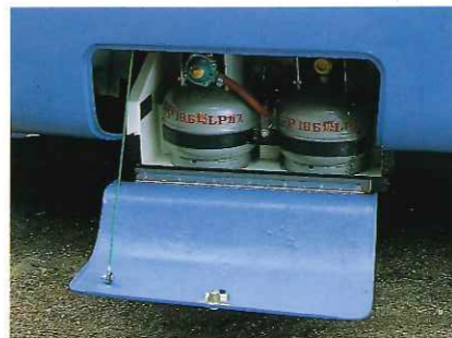
■確実に収納された2kg/m 3 LPボンベ2本。
