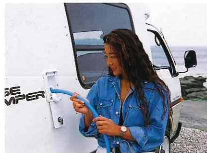
● 清水タンク給水口。
