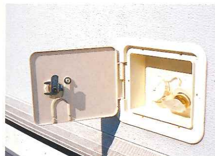
■給水口&ホース注水及び水道直結式
