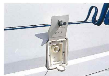
清水タンク給水口
