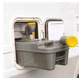
③ カセットトイレタンクドア 汚物タンクの取出し口です。
