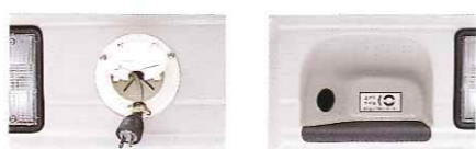
⑫ ACケーブルハッチ ⑭ リヤバンパーステップ AC電源のあるキャンプ場では大活躍。ブレーカーをONにして差し込めば自動的にサブバッテリーに充電、冷蔵庫もACで利用できます。(走行中も自動的にサブバッテリーに充電)
