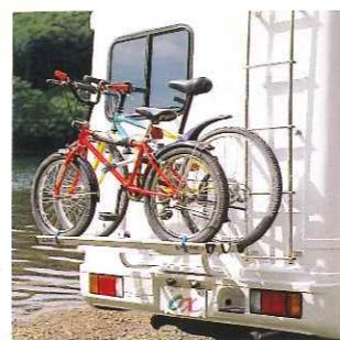
⑨ バイクキャリア (オプション) 自転車を3台まで積むことができます。
