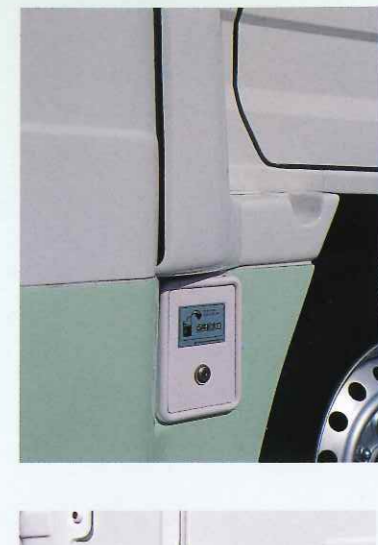
10 リザーブタンク点検口 ラジエーターリザーブタンクの点検口です。
