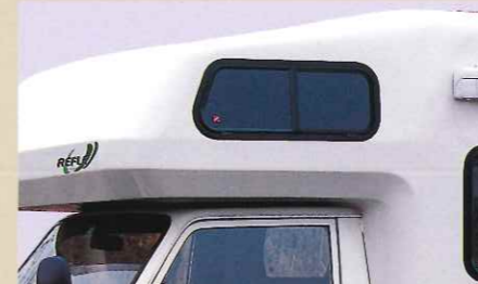
4 バンクベッドサイドウィンドウ バンクベッド両サイドに装着する網戸付ウィンドウ。室内にはカーテンを取り付けます。
