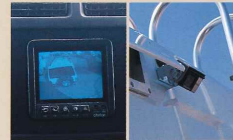
2 バックカメラ&モニター モニターはインダッシュタイプです。ドライバー一人での後進時に役立ちます。
