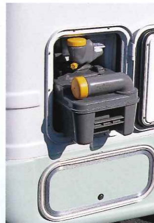
7 カセットトイレタンク 外部から汚物タンクだけを取り出して一般の水洗トイレに処理できます。
