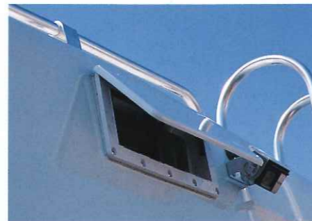
5 レンジフードベンチレーター ファンの操作に合わせて自動開閉します。
