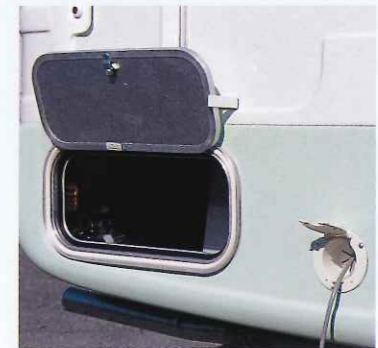
11 リヤ床下長尺物収納庫 長尺物が収納できます。 (4WD車：1800mm、2WD車：1300mm)
