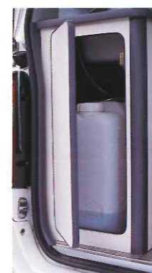
■ 給排水タンク
